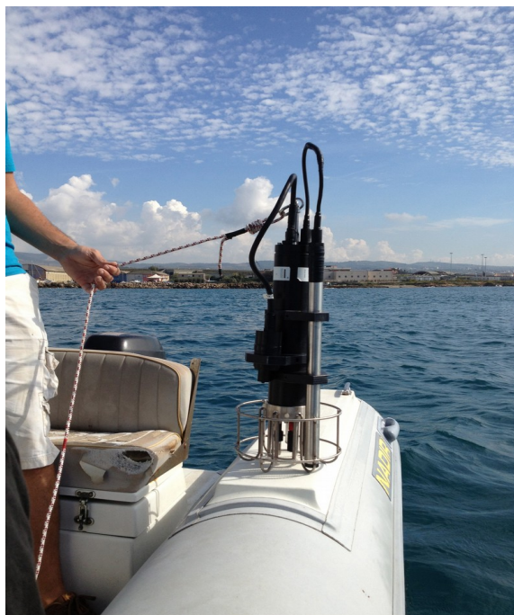
Fig. 9 Profili verticali con Sonda multiparametrica
