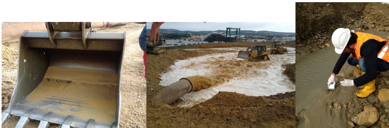
Fig.13 Punti di prelievo e prelievo dei campioni di sedimento
